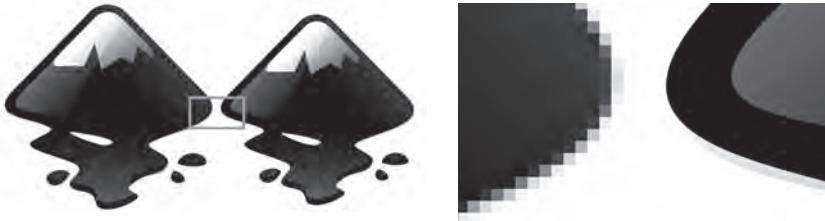
Figuur 1.3: Het verschil tussen een vectortekening (links) en een bitmapafbeelding (rechts)
