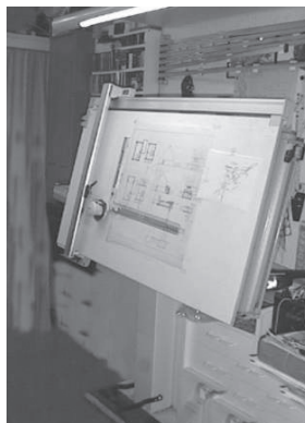
Figuur 1.2 Een traditionele tekentafel, met tekenmachine.
